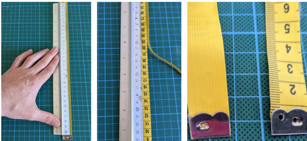
Abbildung 2 Maßband vorbereiten, zuschneiden und Löcher bohren
