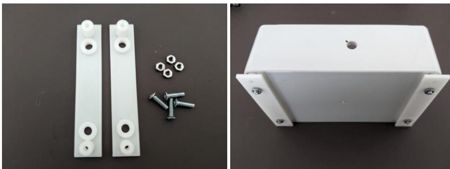
Abbildung 6 Anbringen der Montagehalter an die Sensorbox
