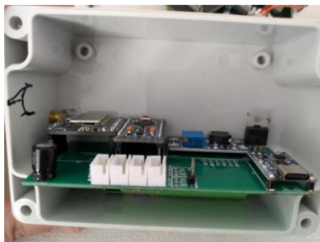
Abbildung 14 PCB Board in die Sensorbox einbauen
