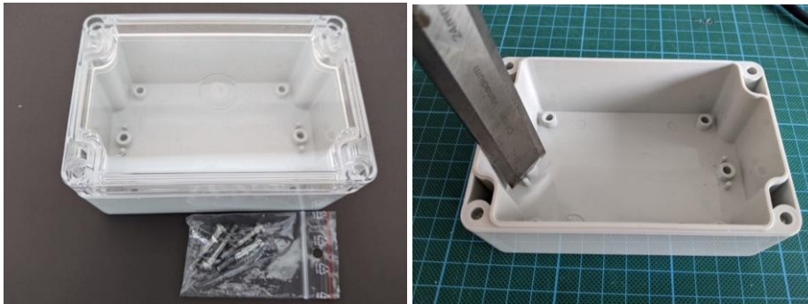
Abbildung 4 Sensorgehäuse, entfernen der Noppen
